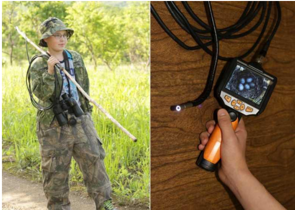
Эндоскоп для осмотра гнёзд птиц, расположенных на деревьях или в дуплах, с цветным дисплеем и подсветкой вокруг микро-видеокамеры.
