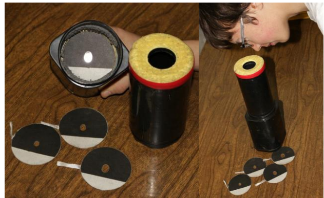
Овоскоп для просвечивания яиц мелких птиц (собственная сборка).
