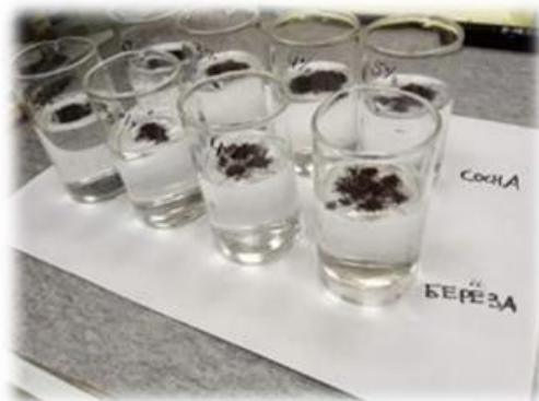
Определение плавучести гидрофобизированных сорбентов
