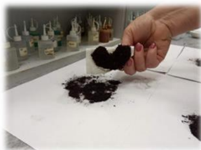
Определение магнитных свойств сорбентов
