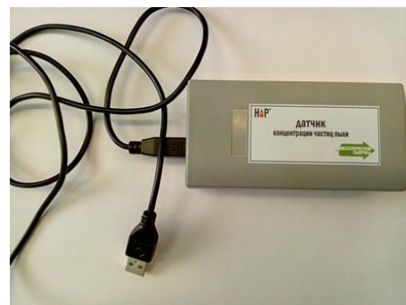
Рис. 2. Экологический датчик измерения концентрации частиц пыли в воздухе
